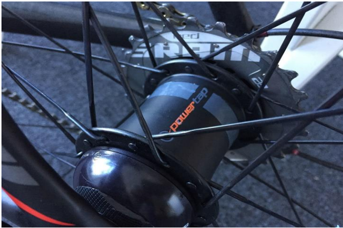
الشكل رقم 2: جهاز قياس الاستطاعة الميكانيكية من نوع Powertap G3 hub
